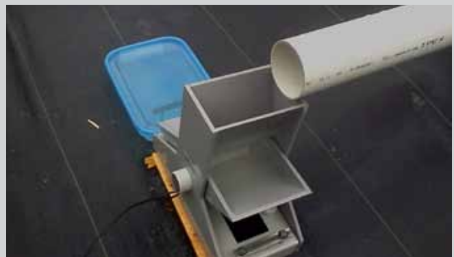
Auge basculeur utilisé pour mesurer les volumes d'eau de lessivage et de ruissellement
